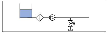
Fig. 21: Overpressure protection
