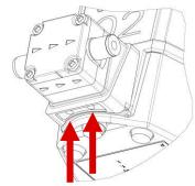
Fig. 1: Discharge outlet
