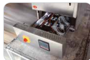
Zásuvka s elektro prvky pece pro snadný servis
