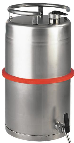
Edelstahl 1.4301 unpoliert Maße: ca. 300 x 530 (D x H in mm) mit umlaufendem Tragegriff, stapelbar, Flamm Sperre im Behälterhals, manueller Vakuum-/Überdruckausgleich in der Schraubkappe, Flamm Sperre in Einfüllöffnung, selbstschließender Zapfhahn, Behälterkennzeichnung nach GefStoffV und BGV A8.
